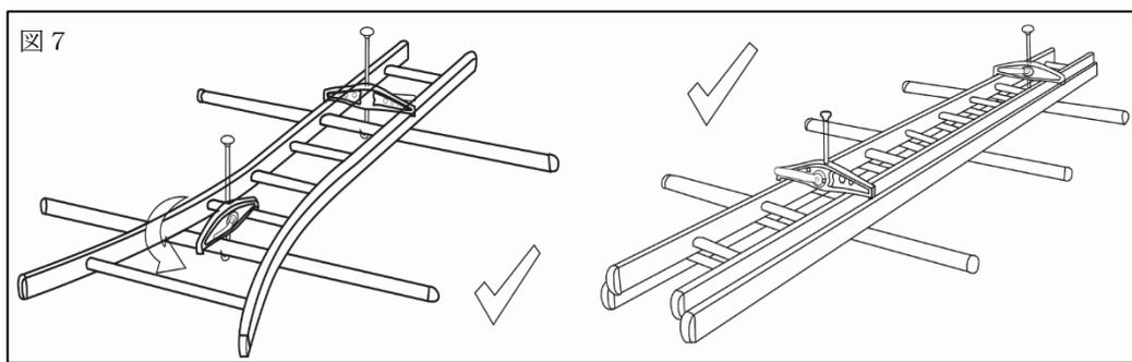
⑥脚立を固定後、鍵を水平方向に回してロックし、レバーが動かないことを確認して鍵を抜いてください（図1、8参照）。
