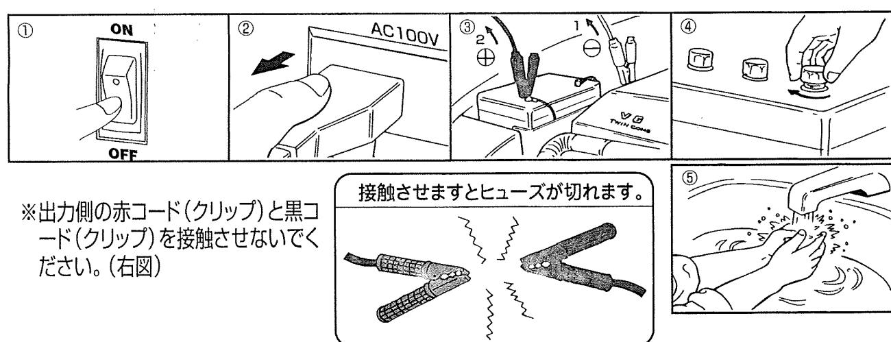
※出力側の赤コード(クリップ)と黒コード(クリップ)を接触させないでください。(右図)
