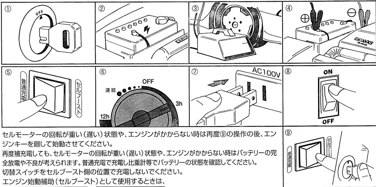
セルモーターの回転が重い(遅い)状態や、エンジンがかからない時は再度⑨の操作の後、エンジンキーを廻して始動させてください。
